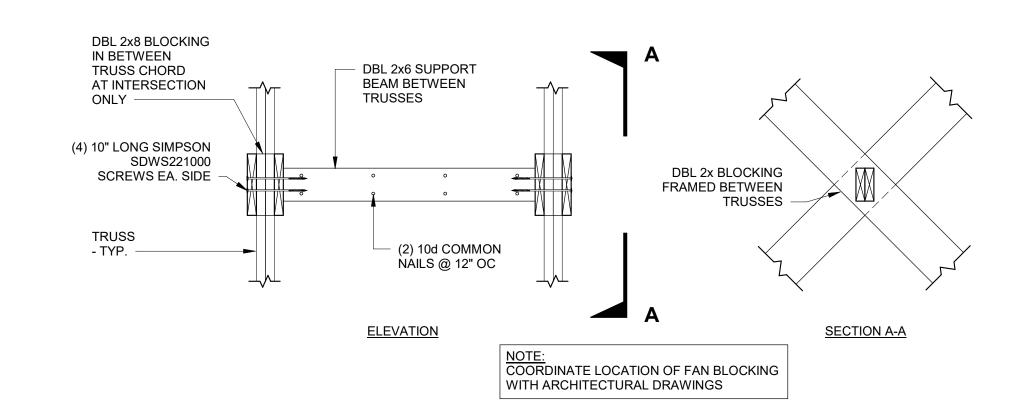
**FAN SUPPORT BEAM DETAIL**
